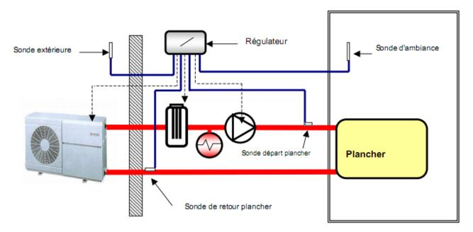
Schéma de principe régulation par loi d'eau en fonction de la température extérieure avec sonde d'ambiance.
