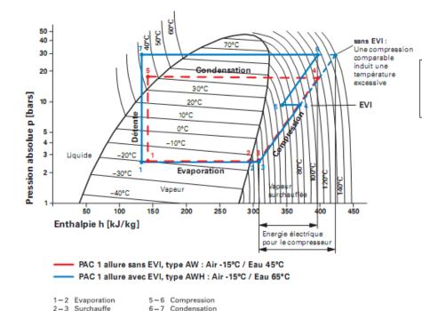
le cycle EVI dans le diagramme de Mollier avec le fluide frigorigène R 407 C (en comparaison, le cycle pompe à chaleur traditionnel est
