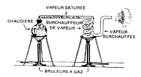
L'expérience se déroule à la pression atmosphérique normale, dans ces conditions l'eau bout à 100°C Dans la chaudière l'eau est en ébullition, on dit que la vapeur est *saturante*, car elle est à la température d'ébullition.
