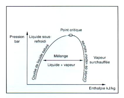
Le diagramme est délimité en abscisse par l'échelle des enthalpies et en ordonnée par l'échelle des pressions. Les courbes de saturation se rejoignent au point critique et divisent le diagramme en 4 zones :
