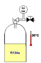
Comme on retrouve plus de vapeurs, la pression augmente... 6,6 bar, c'est la pression d'un mélange liquidegaz de R134a à 30°C.
