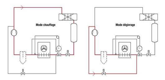
Pendant le processus de dégivrage, le condenseur est contourné au moyen d'un by-pass, et le gaz sous pression provenant du compresseur est directement envoyé vers l'évaporateur. Il est ici très important que la pression soit maintenue élevée en aval du compresseur. La puissance nécessaire pour le dégivrage correspond pratiquement à la puissance électrique absorbée par le compresseur.
